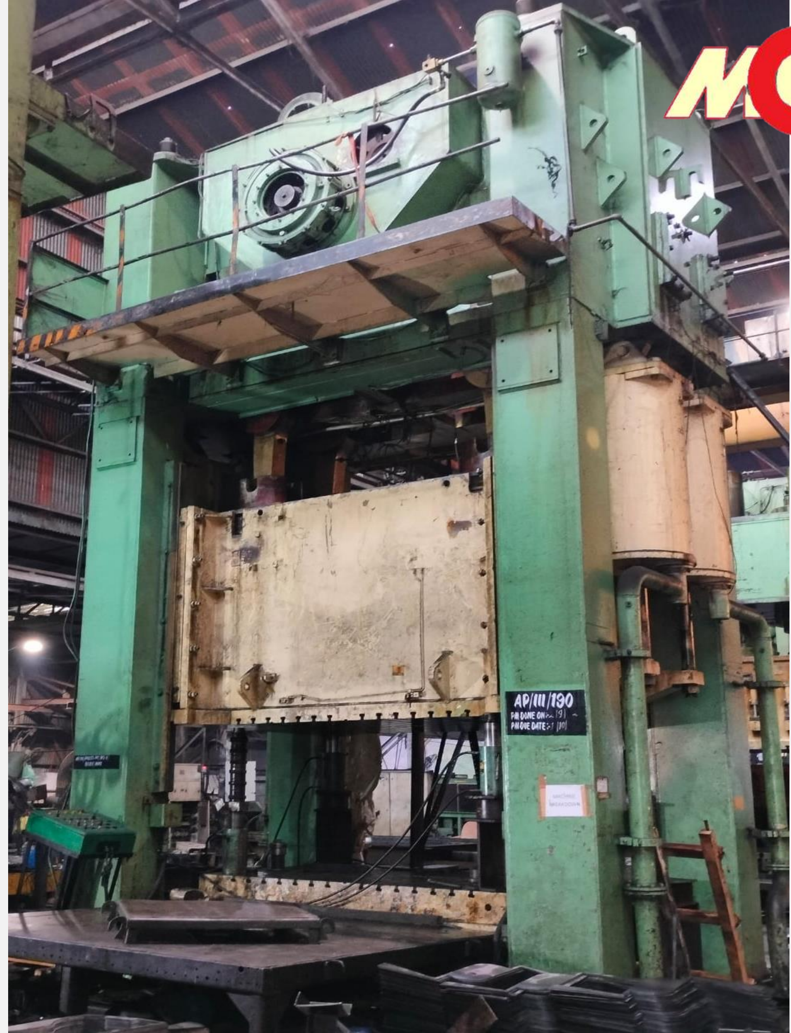
800 T HMT Trimming Press
